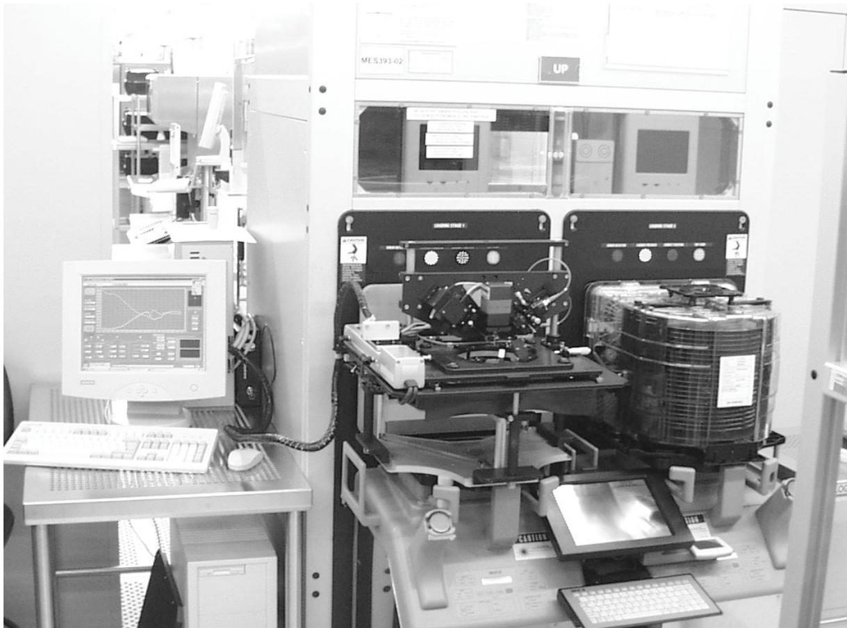
**Abb. 5.18: Kontrolle von DRAM-Linienbreiten mit IPCOS (Gehäuse entfernt) auf dem Scheibenhandhabungssystem in einer Produktionslinie.**
